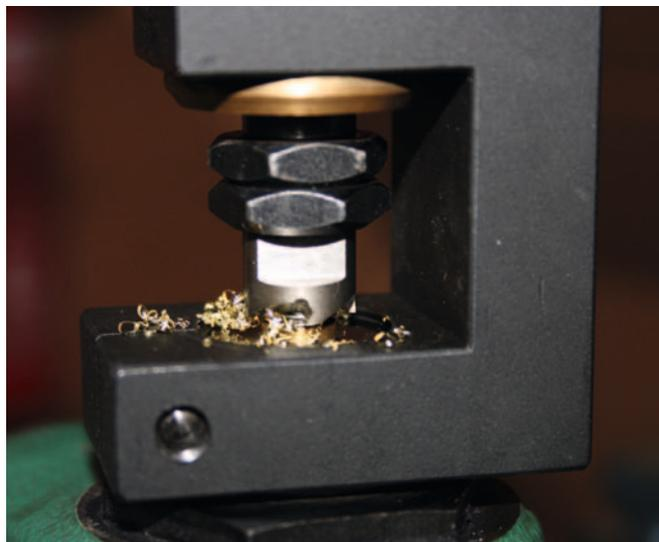
Die Anordnung der sehr scharfen Schneidflächen des Fräskopfs sorgt für einen gleichmäßigen Materialabtrag – ohne großen Kraftaufwand. Der Hülsenmund wird dabei plan abgetragen.
