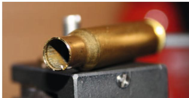
Eine frisch mit dem Keska-Gerät getrimmte und kalibrierte Patronenhülse. Beim Ausziehen sorgt der Innenkalibrierer dafür, dass im Mund der Hülse kein Grat mehr stehen bleibt.
