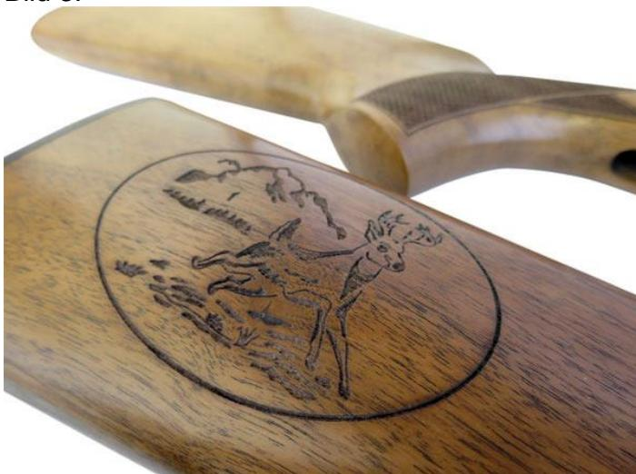
Beispiel einer durch den Laserstrahl erzeugten dekorativen Verzierung auf Holz
